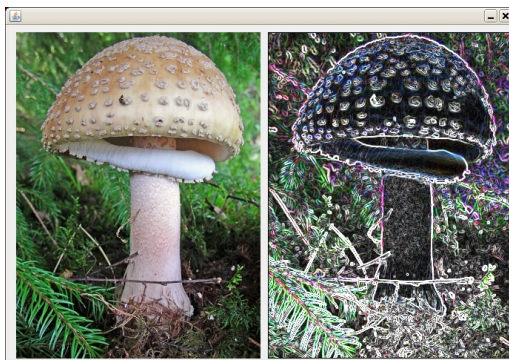
Bild som filtrerats med Sobel-filter.
