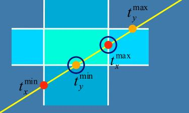
Keep max of t<sup>min</sup> and min of t<sup>max</sup>
