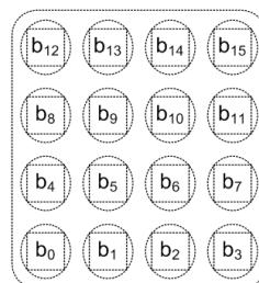
Antag att port D, bit 0..7, kopplats till tangentbordet enligt figuren till höger. Eftersom flera tangenter kan tryckas ned samtidigt vill vi göra en ”kortslutningssäker” lösning för koïncidenssökning av tangentbordet. Utgångarna ska därför vara OPEN-DRAIN. De avlästa kolumnerna ska vara PULL UP.
