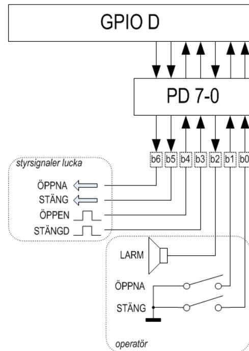
För att kunna kontrollera att det inte tar mer än 1 sekund att öppna eller stänga luckan krävs en funktion för realtidsfördröjning användas. Du kan förutsätta att en sådan blockerande funktion `void delay_100ms(void);` som fördröjer det anropande programmet i 1/10 sekund finns tillgänglig. Du kan alltså använda denna men behöver inte visa funktionen här.
