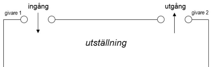
Man behöver nu ett mikrodatorbaserat system som håller reda på hur många besökare som befinner sig i lokalen och konstruerar därför en *givarkrets* med gränssnitt där givarsignalerna ansluts till de åtta minst signifikanta bitarna i port E hos en MD407.
