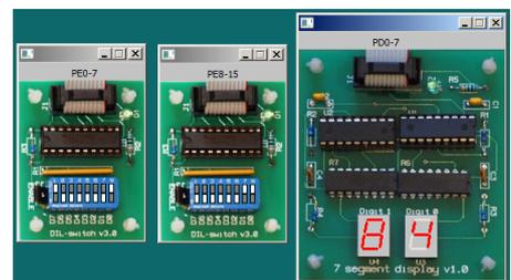
Utgå från att alla portar är korrekt initierade och skriv ett program i ARM v6 assemblerspråk som kontinuerlig läser de inställda värdena från DIL-strömbrytarna, adderar dessa och skriver resultatet till displayen. Om summan är större än 255 ska **FF** skrivas till displayen.
