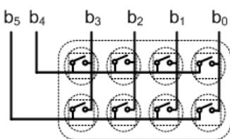
Bit 0-3 kopplas till ingångar, bit 4 och bit 5 kopplas till utgångar hos port E.
