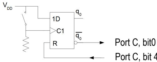
Den externa avbrottsmekanismen (EXTI) ska användas för att detektera knapptryckningar. Ingen hänsyn behöver tas till eventuella kontaktstudsar.
