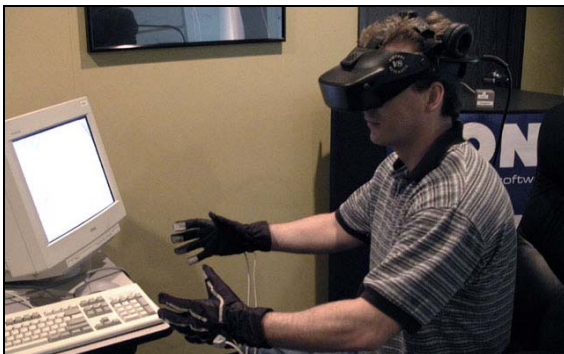
HMD (Head Mounted Display) och Pinch gloves (datahandskar) (EON, 2002)
