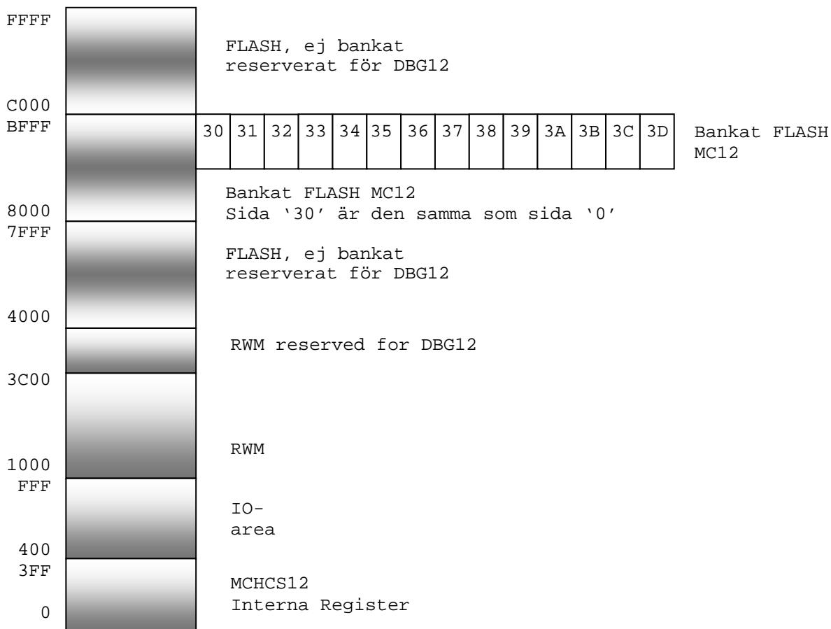
DBG12 använder internt RWM 3D00-3FFF. Applikationsprogram kan använda intervallet 1000 t.o.m. 3CFF.
