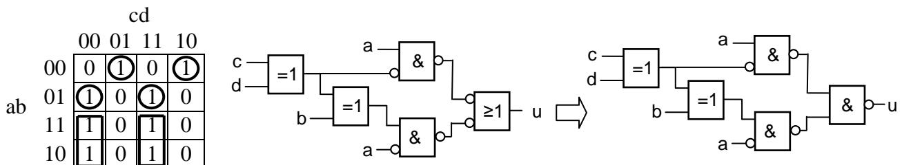
(Ring på ingångar i figuren ovan betyder att signalen inverteras innan den når grinden.)
