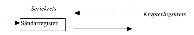
En extern krypteringskrets är inkopplad till ett datorsystem enl. figur. Tecken som sänds till krypteringskretsen krypteras automatiskt, och sänds tillbaka i krypterad form. För kommunikationen till och från krypteringskretsen används en *seriekommunikationskrets*.
